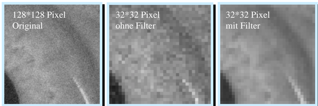
Bild 4.3.3.1 Veranschaulichung der Reduktion hochfrequenter Störungen durch Mittelwertfilterung
