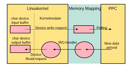
In diesem Schaubild ist noch einmal ein Überblick über die von uns verwendeten Puffer. Das Kernelmodul besitzt noch einen eigenen Ringpuffer, in dem die vom PPC empfangenen Daten abgelegt werden. User-Space Applikationen können jetzt über ein char-Device mit dem Kernelmodul kommunizieren und hierüber Kommandos an den PPC absetzen, bzw. empfangene Daten aus dem Ringpuffer des Kernelmoduls auslesen.
