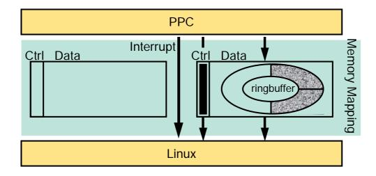
Wenn der Linux-Rechner einen Interrupt von der Karte bekommt, werden alle Daten aus dem Ringpuffer ausgelesen und in einen eigenen Puffer geschrieben, danach wird die Semaphore gelöscht.
